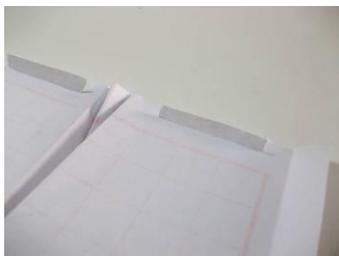
中间的尾翼与两侧的挡风板都是为了“抬头”而设计。这两种构造都使得尾部被迎面而来的气流下压，再考虑重心的位置，从而使得机头获得向上的力矩。因此，机头被迎面的气流压上升了。
