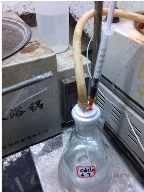
9. 将注射器插入软木塞中，逐滴缓慢地将 NaHTe 溶液加入，可观察到溶液由无色透明变为棕黄色；
