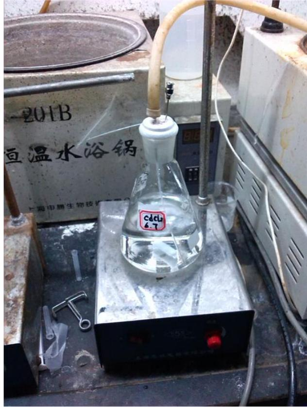
8. 用注射器吸取 NaHTe 溶液 0.24mL，并及时补上 NaHTe 溶液的封口胶；
