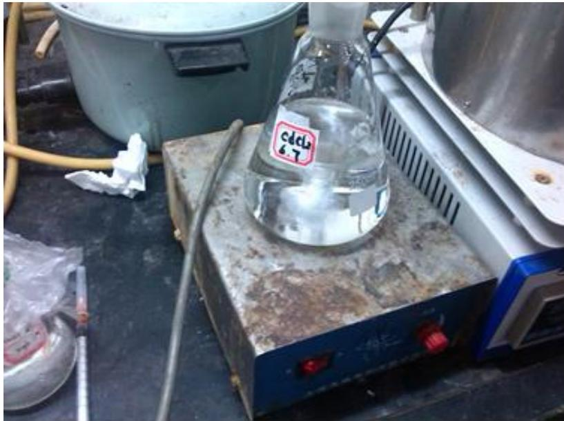
6. 加入 5mol/L 及 1mol/L 的 NaOH 溶液，利用电子 pH 计，调 pH 至 9，溶液由澄清透明变为白色浑浊液，后又变为澄清透明；
