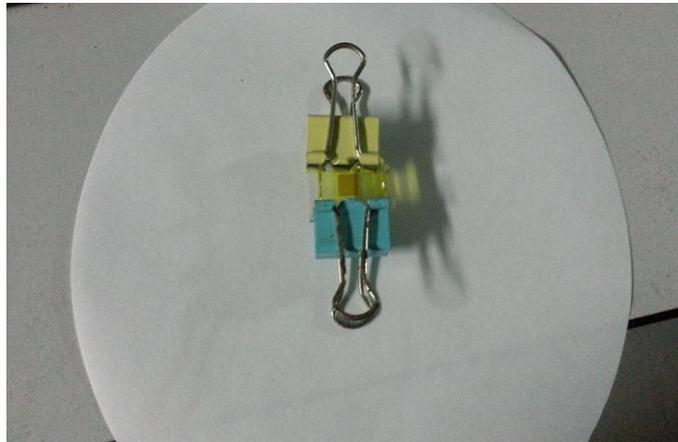
16.将两片导电玻璃作为电源的两级分别接在太阳能测试系统两端，用模拟太阳光照射太阳能电池片。
