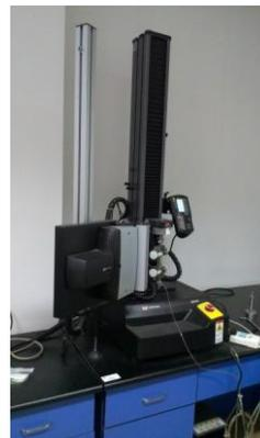
图 1: Instron 万能试验机
