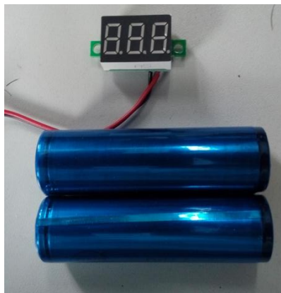
电池和 LED 数码管充当的电压表
