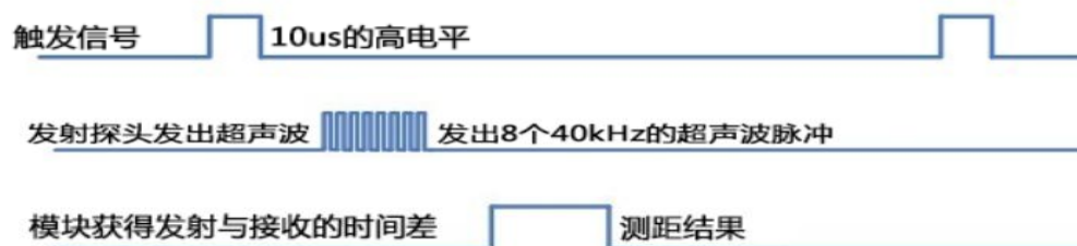
图 4 超声波测距原理（信号时序）
