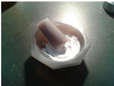
(3) 将研好的 KBr 粉末加入模具中，尽量使粉末平铺，模具中央滴入约半滴油样一
