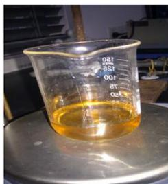
3、将 NaOH 热溶液和地沟油样品倒入烧杯中，用磁力加热搅拌器加热搅拌。加热过程中现产生小气泡，后有刺鼻气味。油样分层，表面漂浮固体杂质。
