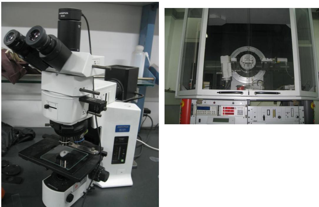
图 5，实验用于测量样品结构的显微镜和 X 射线衍射仪。显微镜的最大放大倍数可以达到 2000 倍，清晰显示样品表面的细微结构；X 射线衍射仪主要用于测量原子结构（原理不清楚）。
