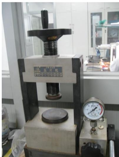
图 2 实验使用的电子天平、研磨样品的研钵、将粉末压成薄片的液压机等
