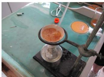
油样煮沸后明显分层，将上层清液倒入试管中
