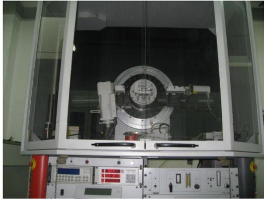
图 4 实验用于测量样品结构的 X 射线衍射仪
