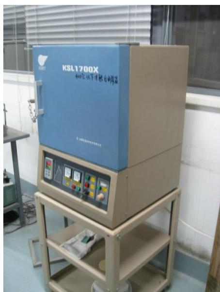
图 3 样品烧结和氧气氛保温所使用的炉子
