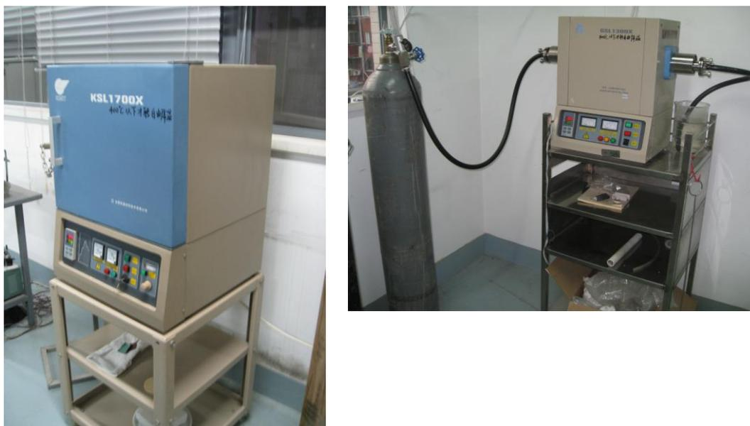
图 4 是样品烧结和氧气氛保温所使用的炉子
